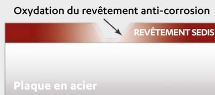
La **résistance à la corrosion** de ce traitement SEDIS est nettement supérieure aux autres traitements classiques comme le zingage. Ses meilleures performances sont dues à sa caractéristique de protection cathodique.
