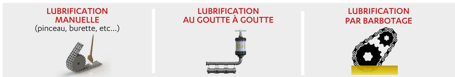
**En transmission**, ces quatre modes de lubrification sont utilisés et le choix doit être fait en fonction du type et de la vitesse linéaire de la chaîne. **En levage**, on utilise souvent la lubrification manuelle et le goutte à goutte mais également des dispositifs automatiques par pinceau ou projection.
