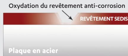
La **résistance à la corrosion** de ce traitement SEDIS est nettement supérieure aux autres traitements classiques comme le zingage. Ses meilleures performances sont dues à sa caractéristique de protection cathodique.
