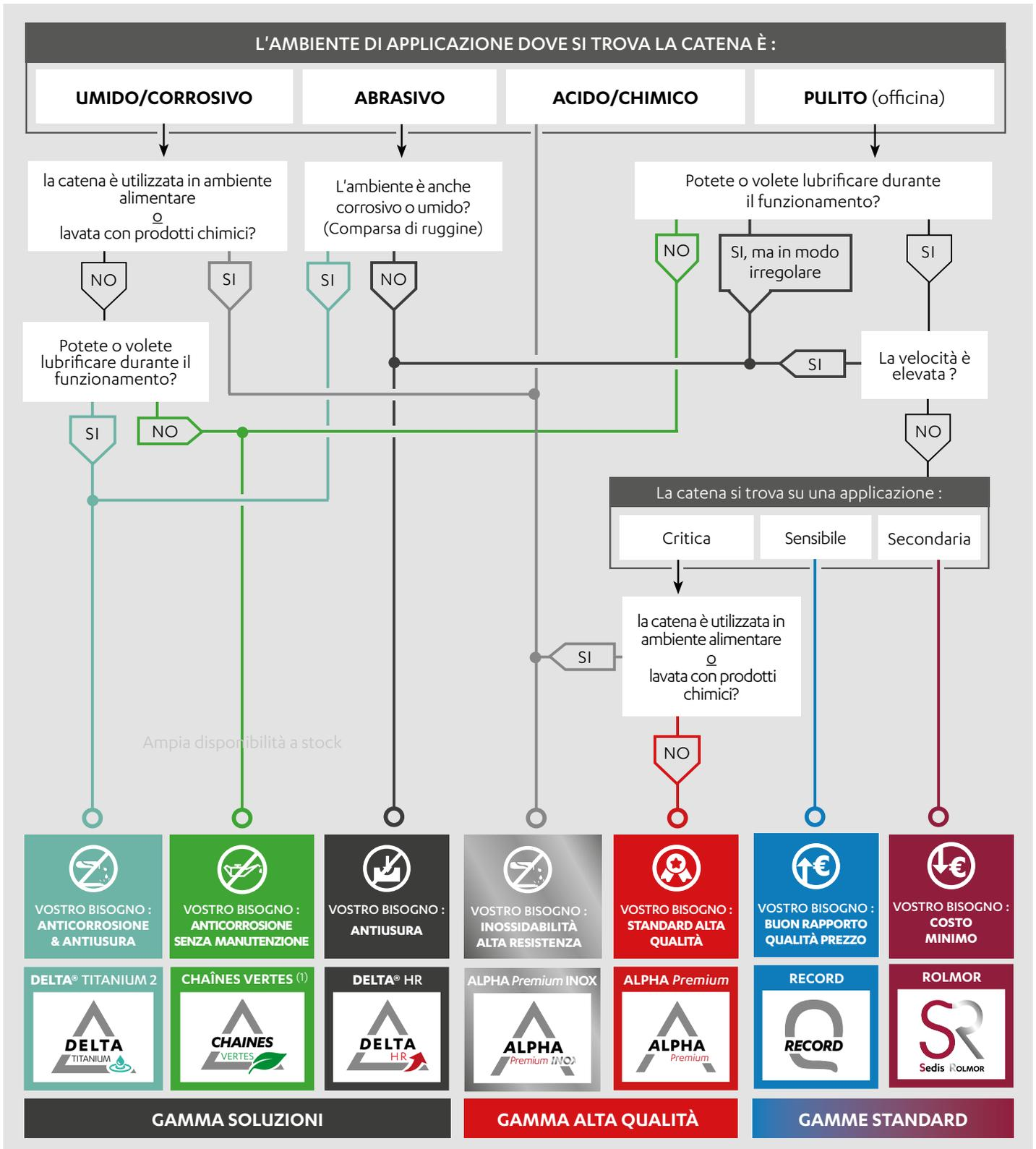
(1) Definizione della catena Verte idonea in base alle condizioni di utilizzo, da parte del nostro ufficio tecnico
