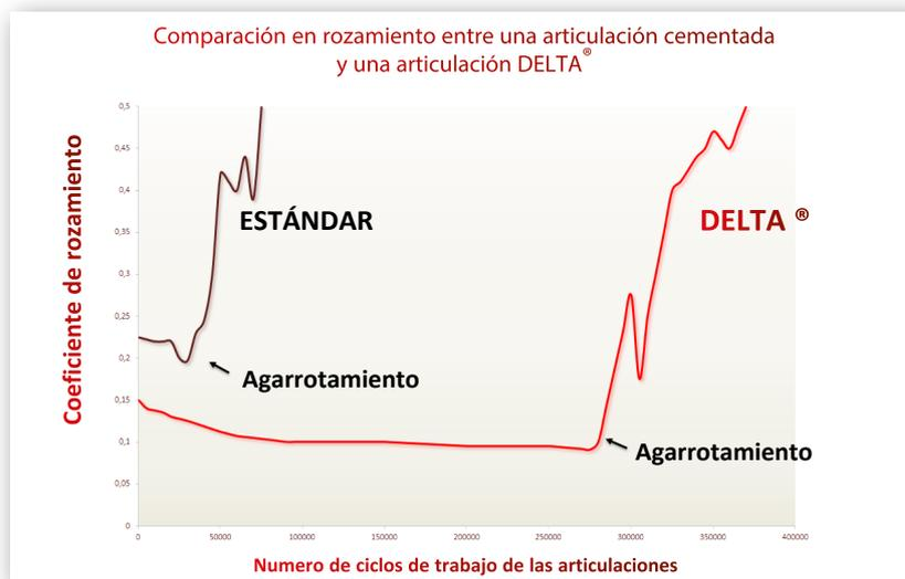
Gracias a la dureza superior, un bajo coeficiente de fricción y una afinidad química compatible, las cadenas **DELTA®HR** tienen una **vida útil más larga que las cadenas estándares**, particularmente en las aplicaciones difíciles (abrasión, tirones, choques,...).
