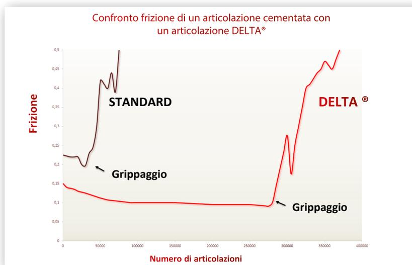
Grazie alla durezza superiore, un basso coefficiente d'attrito e delle affinità chimiche compatibili, le catene **DELTA<sup>®</sup> HR** hanno una **durata di vita superiore alle catene standard**, in particolare nelle applicazioni severe (abrasione, urti, difficile lubrificazione,...).
