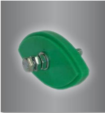
Patin elliptique OVR en polyéthylène à haute densité moléculaire, conçus pour une tension simple de chaînes simple, double ou triple fonctionnant à une vitesse < 0,35m/s et à une température < 80°C.
