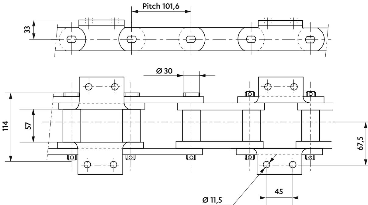
**CHAIN FOR INCLINED CARRIER OF ASPHALT**
