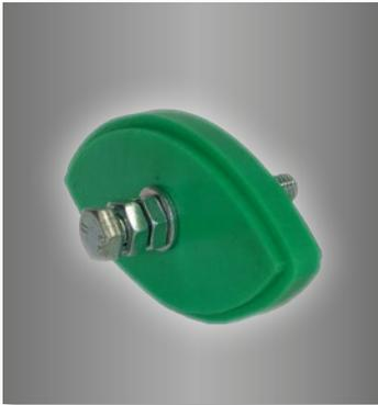
Elliptische OVR-Kettengleiter aus Polyethylen mit hoher molekularer Dichte, ausgelegt für eine einfache Spannung auf einer Einfach-, Zweifach- oder Dreifachkette mit einer Betriebsgeschwindigkeit von <math><0,35\text{m/s}</math> und einer Temperatur von <math><80^\circ\text{C}</math>.
