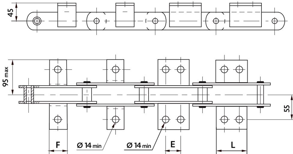
Disposition des attaches à la demande : attaches d'un seul côté ou des 2 côtés de la chaîne, sur maillons extérieurs ou intérieurs.
