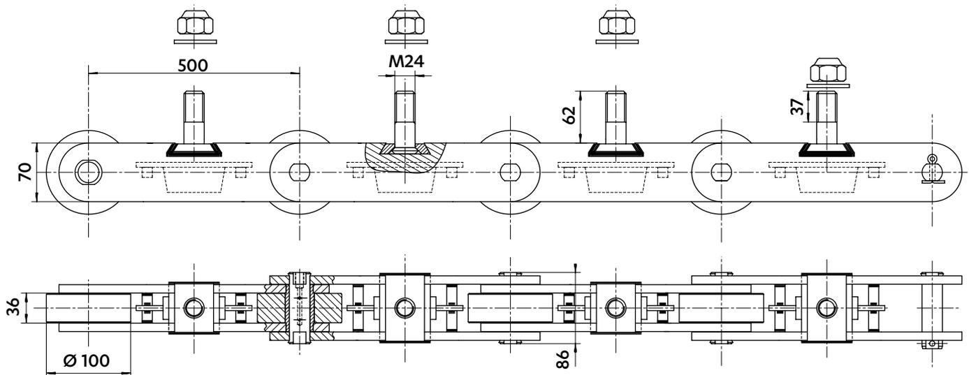
Chaîne en acier inoxydable 316L équipée de galets plastiques
