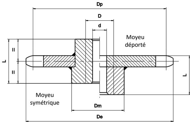
Toutes nos roues sont livrées avec la denture brute d'oxycoupage ou de fonderie pour les chaînes équipées de galets lisses et de galets épaulés. Les roues pour chaînes à douilles et à rouleaux sont à denture taillée. Nos roues standards sont à moyeu déporté avec possibilité de réaliser des roues à moyeu symétrique.
